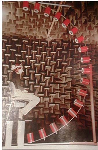
Figura 8.12. Obtención de las dos funciones HRTF (una para cada oído, H_L y H_R ) en una cámara anecoica con una precisión de 10^\circ .
