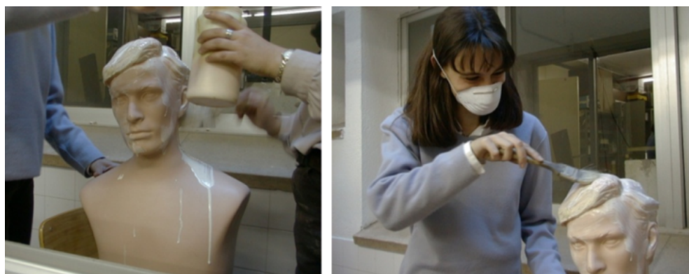
Figura 8.33. Aplicación de distintas capas de látex a un maniquí textil comercial para hacer un maniquí HATS experimental.
