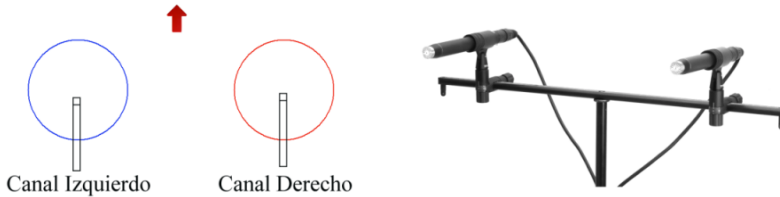
Figura 8.28. Izquierda: configuración estéreo AB con micrófonos omnidireccionales o alternativamente de tipo cardiode. Derecha: imagen de un montaje real.
