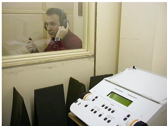
Figura 4.5. Audiómetro Maico MA52 con auriculares Telephonics TDH-39P y cámara sorda donde se realizaron las audiometrías.
