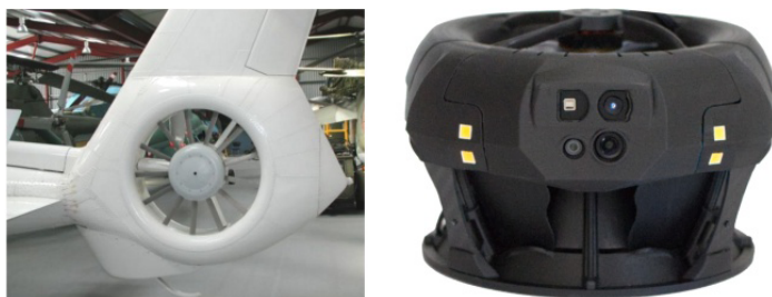
Figura 12.40. Izquierda: primer rotor de cola silencioso de un helicóptero de los años ochenta. Derecha: vista frontal de un dron autopilotado con protección acústica.
