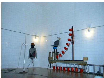
Figura 8.13. Sistema para la obtención de las HRTF, desmontado, junto a un maniquí experimental.
