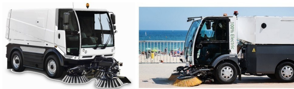
Figura 12.21. Ejemplos de barredora-limpiadora. Izquierda: con propulsor diesel. Derecha: con propulsor eléctrico.
