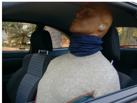
Figura 8.35. Detalle de la posición del maniquí sentado en el interior de un vehículo para la medida de la calidad del sonido de cierre de puerta.
